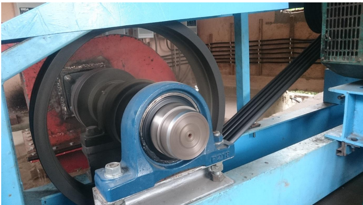
Keilriemengetriebe und Lager der Zwischenwelle, im Hintergrund sind Kupplung und Turbine zu sehen
