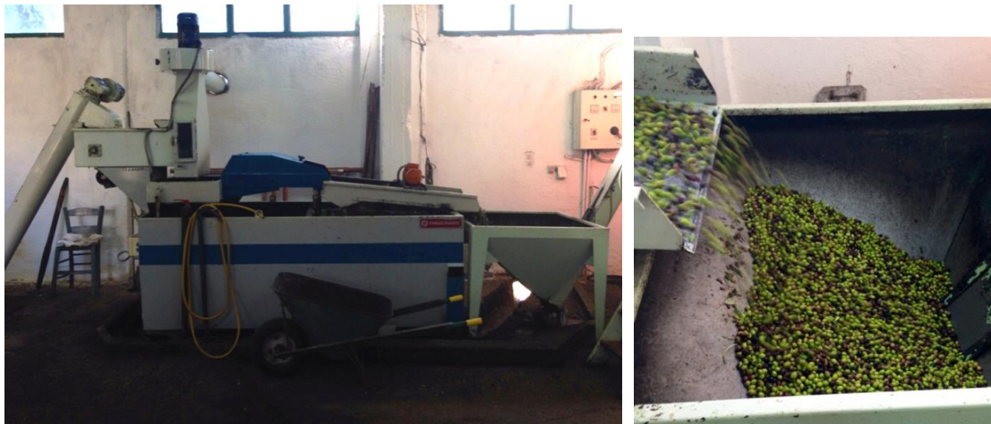
Abbildung 7: Reinigung der Oliven mit Waschwasser (2015)
